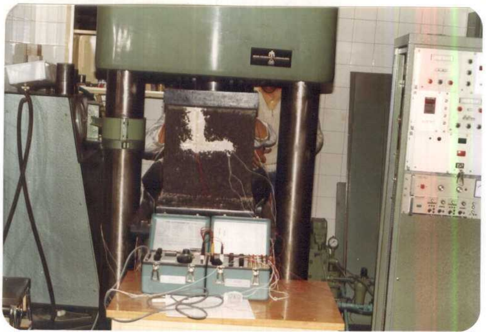
FOTO N° 15 ENSAYO DE COMPRESION SIMPLE CON PROBETA DE 40 cm. DE ARISTA.
