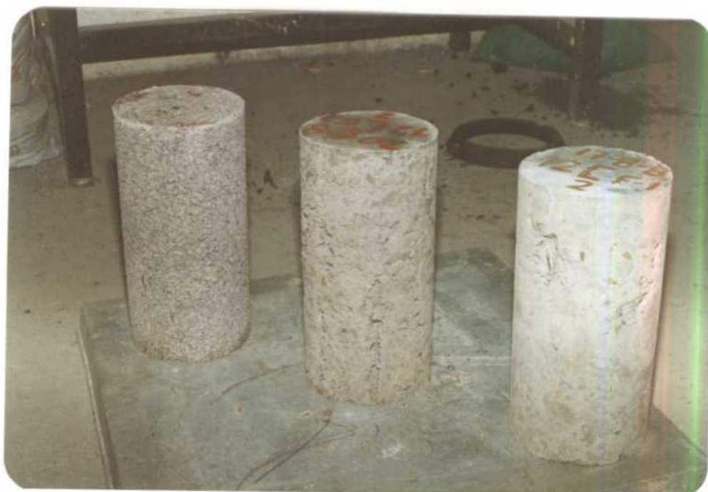
FOTO N° 7 PROBETAS DE LOS TRES TIPOS DE ESTERILES EMPLEADOS
