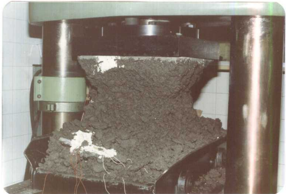
FOTO N° 16 ROTURA TIPO EN ENSAYO DE COMPRESION SIMPLE A GRAN ESCALA.
