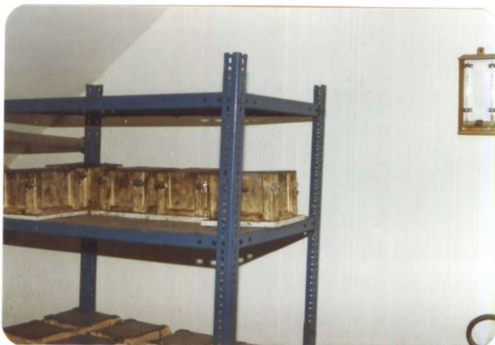
FOTO N° 5 ALMACENAMIENTO DE PROBETAS CUBICAS EN CAMARA HUMEDA
