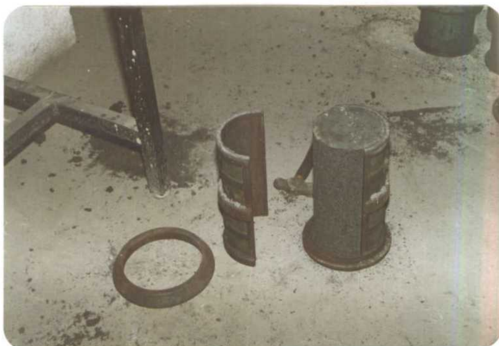
FOTO N° 3 DESMOLDEO DE LAS PROBETAS CILINDRICAS
