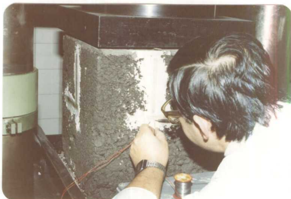
FOTO N° 14 CONEXIONADO DE BANDAS EXTENSOMETRICAS DE GRAN LONGITUD.
