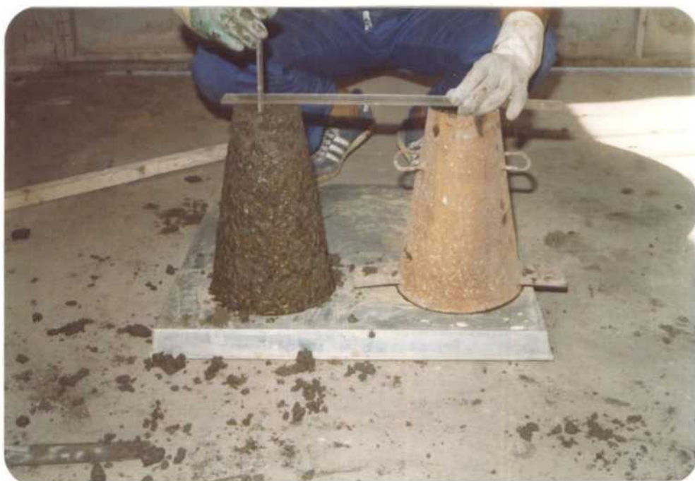
FOTO N° 1 ENSAYO CON EL CONO DE ABRAMS
