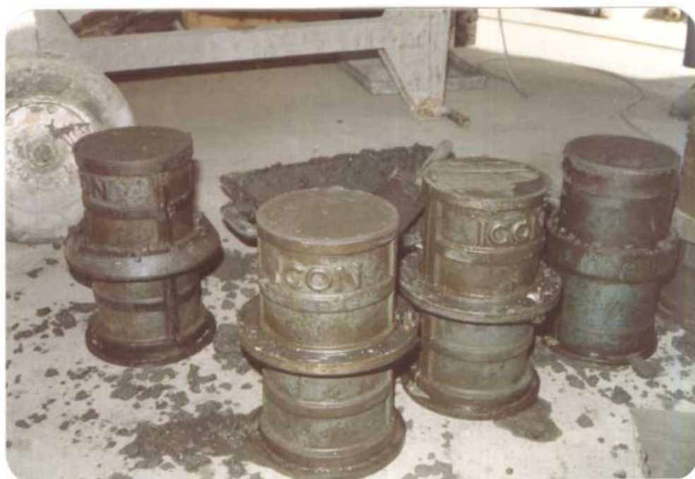
FOTO N° 2 MOLDES PARA LA FABRICACION DE PROBETAS CILINDRICAS.
