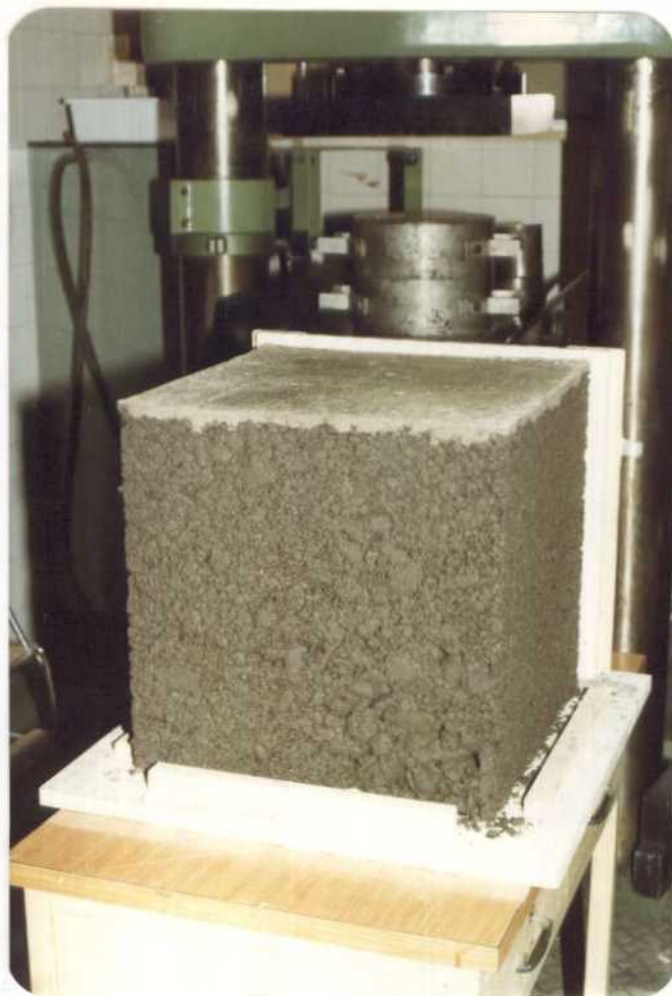
FOTO N° 13 DESMOLDEO DE PROBETAS CUBICAS DE 40 cm. DE ARISTA PARA ENSAYO A COMPRESION SIMPLE A GRAN ESCALA.
