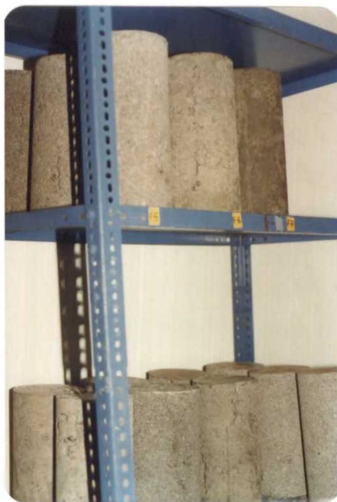
FOTO N° 4 ALMACENAMIENTO DE PROBETAS CILINDRICAS EN CAMARA HUMEDA.
