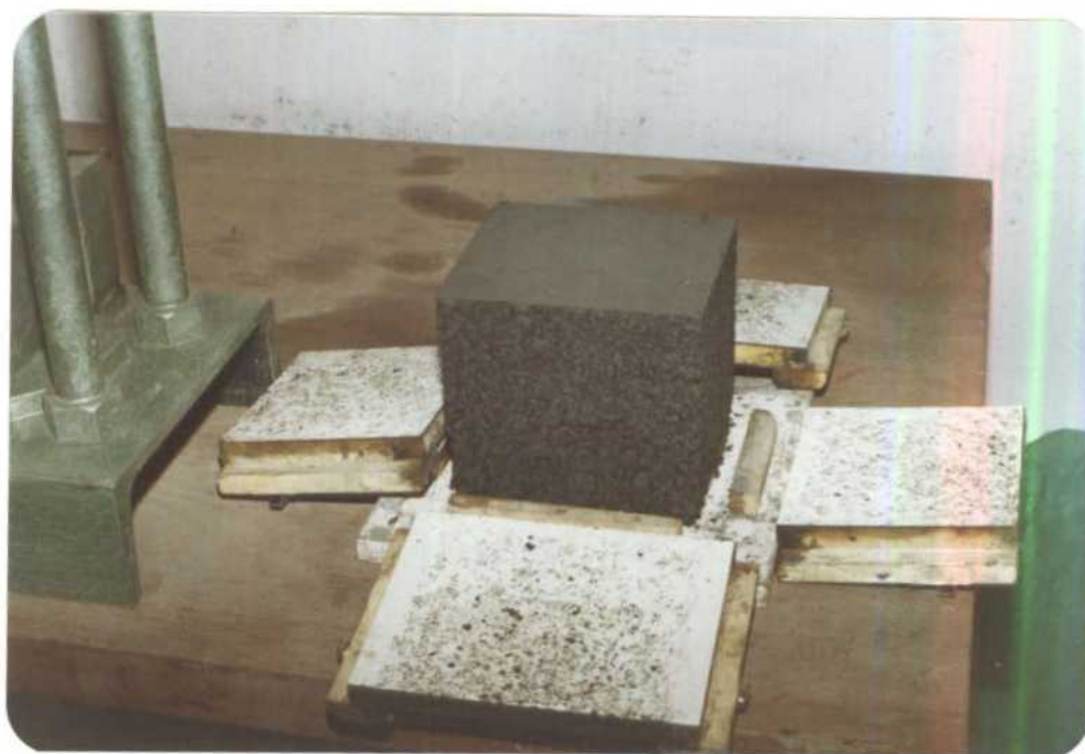
FOTO N° 10 DESMOLDEO DE LAS PROBETAS CUBICAS PARA ENSAYOS DE CORTE.
